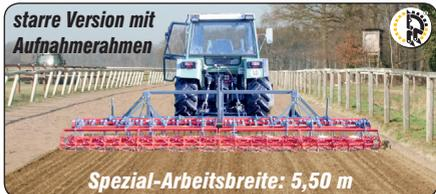
Der Platz-Max Turf wurde speziell für den Einsatz auf Rennbahnen entwickelt: hier ist ein schnelles Glätten der weitläufigen Bahnen zwischen einzelnen Rennen oder während des Trainings erforderlich.
