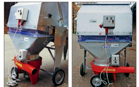
Anstatt der Strohhexe kann auch ein Wagen, ein Behälter oder ein Förderband unter dem Ballenauflöser platziert werden.
