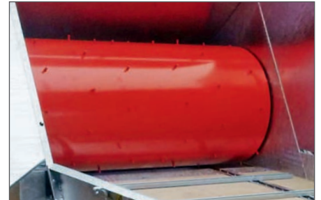
Frästrommel mit aufgeschweißten Zinken, Getriebemotor und Kettenantrieb, Motorleistung für Frästrommel: 5,5 Kw 400 n
