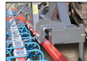
Der 5,50 m breite Platz-Max Turf Star besteht aus zwei Planern mit vier Teilwalzen, die an einen soliden Trägerrahmen gekoppelt werden.
