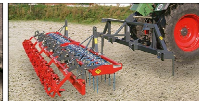
Der 5,50 m breite Platz-Max Turf Star besteht aus zwei Planern mit vier Teilwalzen, die an einen soliden Trägerrahmen gekoppelt werden.
