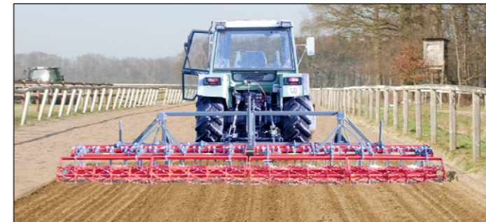
Der 5,50 m breite Platz-Max Turf Star besteht aus zwei Planern mit vier Teilwalzen, die an einen soliden Trägerrahmen gekoppelt werden.
