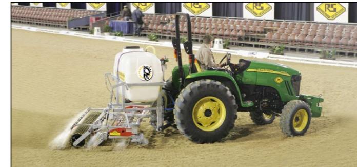
Der Platz-Max-Rain ist standardmäßig korrosionsbeständig feuerverzinkt
