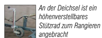
An der Deichsel ist ein höhenverstellbares Stützrad zum Rangieren angebracht
