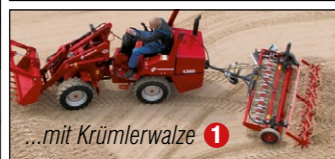
An der Deichsel ist ein höhenverstellbares Stützrad zum Rangieren angebracht
